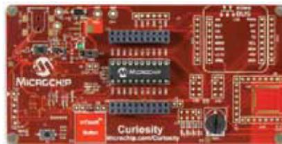
Рис. 1. Отладочная плата Curiosity (8-bit)
