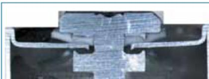
Рис. 3. Конструкция LiSOCl<sub>2</sub> батареи VARTA
