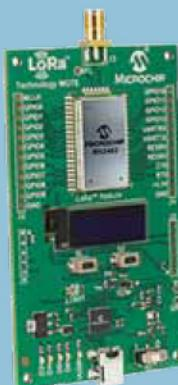
Отладочный комплект «RN2483 LoRa™ Mote» — это конечное устройство «класса А» сетей LoRaWAN™, основанное на модеме LoRa™ RN2483. Плата «RN2483 LoRa™ Mote» в автономном режиме имеет батарейное питание и предоставляет платформу для демонстрации возможностей сети LoRaWAN работать на большие расстояния, а также со-вместимость соединений
