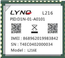
Помимо LBS, передачи данных по GPS и управления AT-командами по UART, а также поддержки BT3.0/4.0, L216 обеспечивает корректную зарядку аккумулятора (Charging manage) и AGPS; L216E – более полнофункциональная версия комбо-модуля, помимо стандартного функционала L216/L218, поддерживает также две SIM-карты и аппаратный Wi-Fi интерфейс (настраивается программно). L216AE – имеет на борту увеличенный объем памяти, доступной как для хранения неких переменных, так и для размещения пользовательского ПО.
