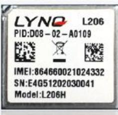
**L206C** является полной калькой модуля **SIM800C** с памятью в 24 Мб на борту. **L206CD** является полной калькой модуля **SIM800C** с памятью в 32 Мб на борту. Полная калька – это не только pin-to-pin соответствие, но и AT-команды, тщательно гармонизированные с 800-й серией модулей SIMCom. Общая идея – меняем один модуль на другой, и всё работает.
