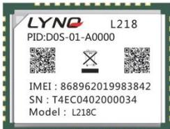
Комбомодули (GPRS+GNSS(dual mode) + BT 3.0/4.0) компании Mobictek выпускаются на основе чипсета MTK2503 в двух основных форм-факторах, в компактных корпусах 17x19x2.3 мм (L216) и 14.5x18.5x2.3 мм (L218). Модули отличаются хорошо продуманной поддержкой режимов сверхнизкого энергопотребления, всесторонне проработанным LBS функционалом и поддержкой Open CPU.
